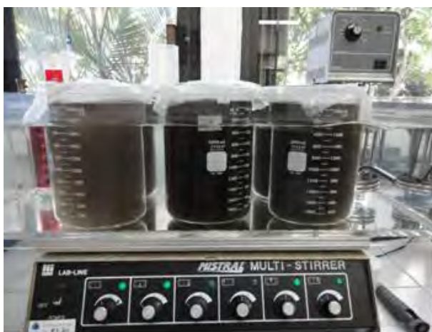
Pruebas de adsorción de fluoruros con carbón de hueso a temperatura constante.
