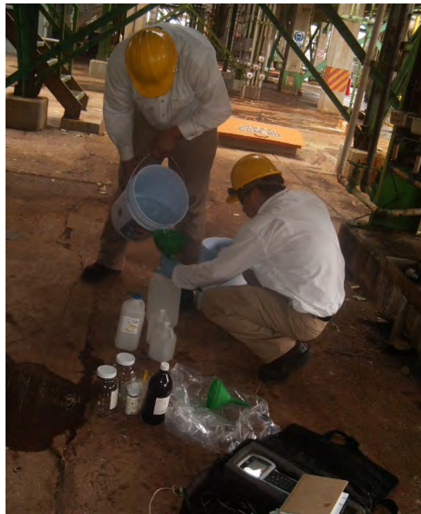
Muestreo de agua en instalaciones de PEMEX-Gas.
