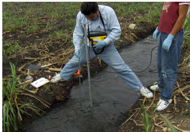
Medición del caudal de agua residual en una regadera de la zona de riego.
