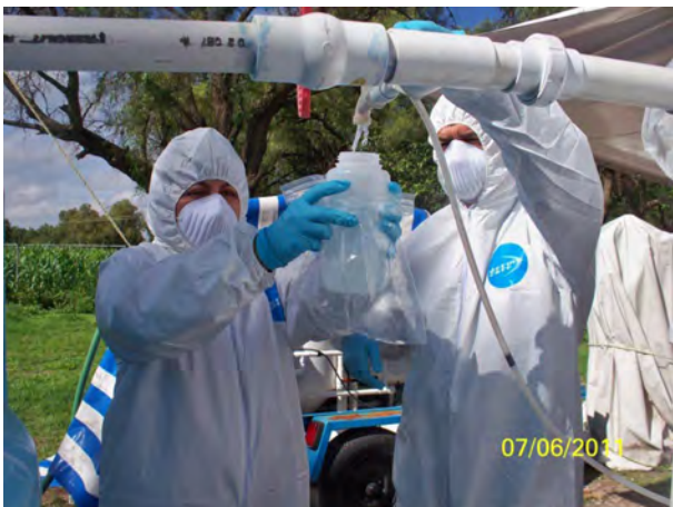
Muestreo de sustancias emergentes en instalación piloto.
